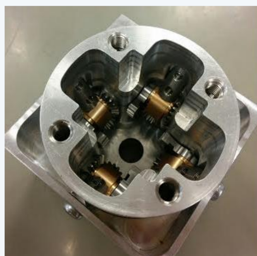
הגלגלי שיניים מורכבים במקומם מימין: לפני הכנסת הבוכנה משמאל: לאחר הכנסת הבוכנה
